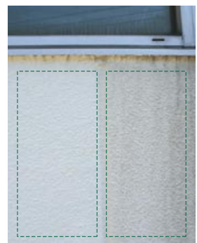
雨すじ試験結果 (左:クリーンマジック塗布/右:塗布なし)
